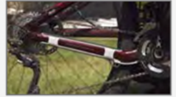
Trek의 Objet500 Connex3는 한 번의 프린팅 작업으로 고무재질을 사용해 내구성이 높은 디지털 ABS 체인 가드를 제작함
