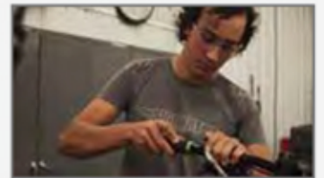
Trek의 공학 기술자인 Patrick Zeigle는 복합 재료 3D 프린터로 제작한 손잡이를 자전거에 장착 후 시험함
